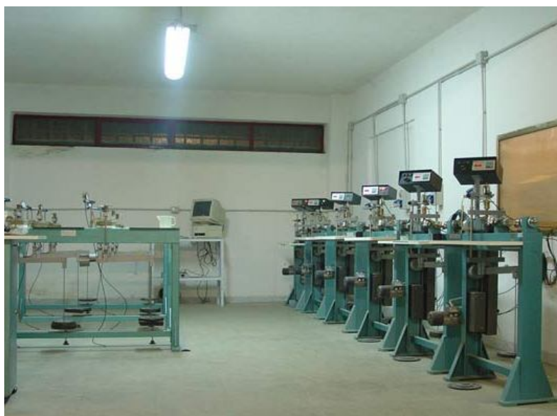
Foto 4: Area prove meccaniche: banchi di consolidazione a sx e macchine di taglio diretto a dx
