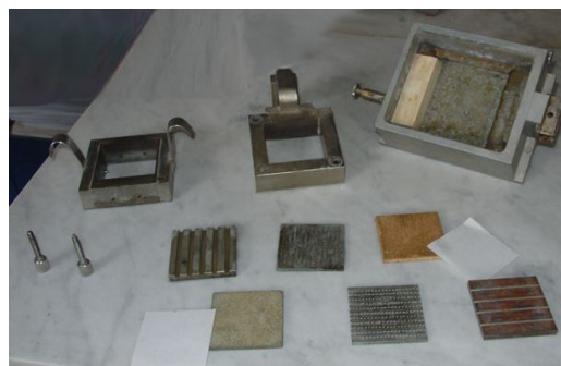
Foto 5: Componenti scatola di Casagrande per prova di taglio diretto
