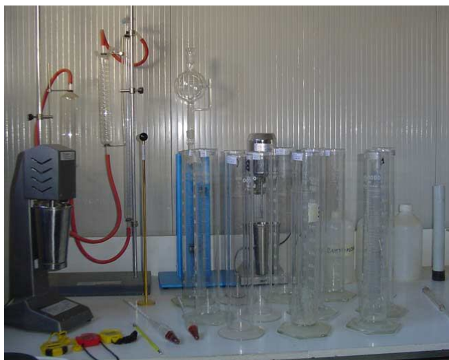
Foto2: Strumentazione completa per l'esecuzione della prova granulometrica per sedimentazione
