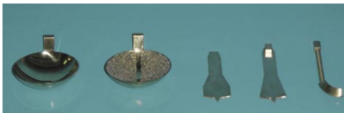
Foto3a, 3b, 3c: Cucchiaino di casagrande (3a), utensile solcatore (3b), apparecchiatura per il limite plastico (3c)
