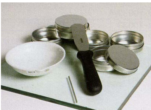
Foto3a, 3b, 3c: Cucchiaino di casagrande (3a), utensile solcatore (3b), apparecchiatura per il limite plastico (3c)
