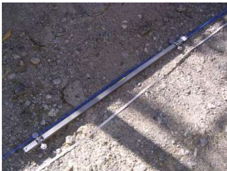
Figura 42 – Inclinometro fisso da foro (serie IN930, Sim Strumenti)
