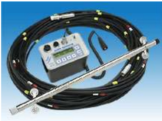
Figura 39 – Sonda Slope Indicator mod. s/n 26180, utilizzata per le misure inclinometriche
