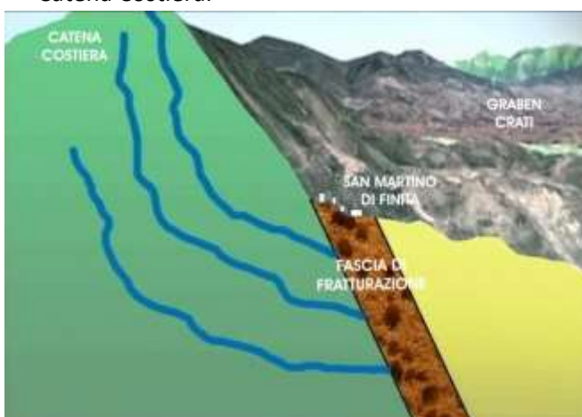
Fig. 10b–Influenza sulla circolazione idrica sotterranea dalla fascia di fratturazione legata alla faglia "S.Fili-Cerzeto-S.Marco Argentano".
