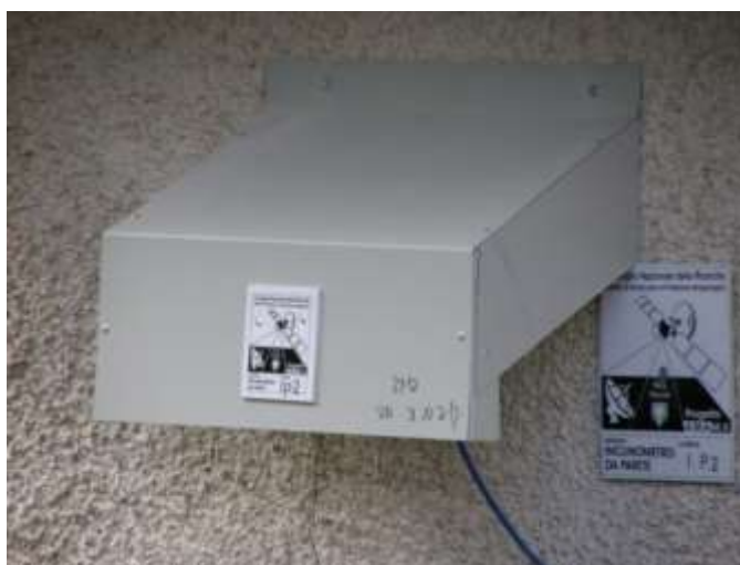
Fig.7 - Particolare della protezione in alluminio realizzata per la protezione degli inclinometri dall'irraggiamento solare.
