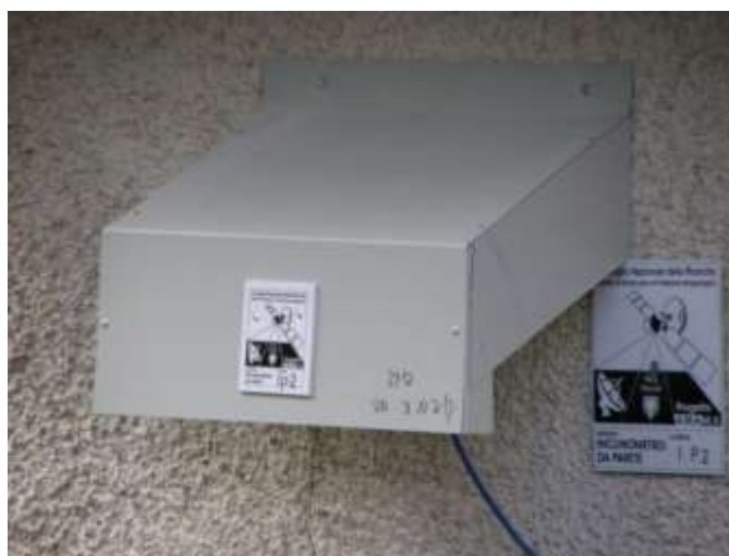
Fig.4 - Particolare della protezione in alluminio realizzata per la protezione degli inclinometri dall'irraggiamento solare.
